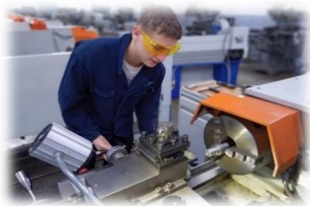
Рисунок 3. Обработка заготовки на токарном станке согласно размерам на чертеже в мастерской колледжа
